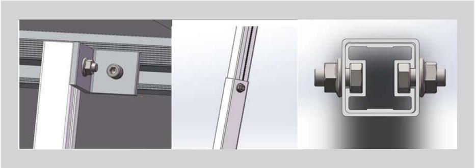
**b.** Calcule la longitud adecuada de la pata trasera de acuerdo con el ángulo requerido. Luego extraiga o acorte el tubo de la pata trasera y bloquee los 2 tornillos, asegurando que las alturas de las patas traseras que se mantengan en la misma línea después del ajuste para que las cargas sean uniformes en cada sección de rieles. Las diferencias de ángulo se muestran en las siguientes imágenes:
