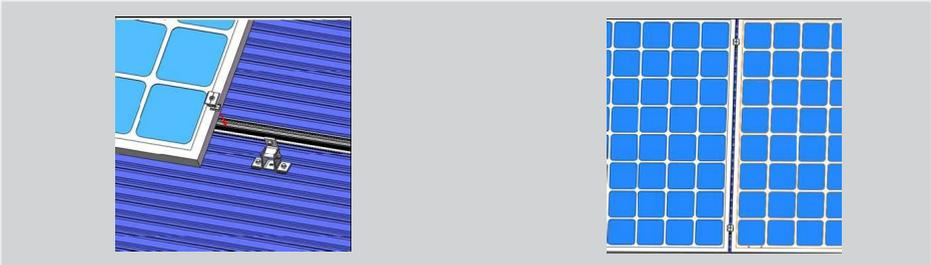
c. Repita el último paso hasta terminar de instalar todos los paneles. Verifique todo el sistema y vuelva a fijar todos los tornillos externos después de terminar de instalar los paneles.
